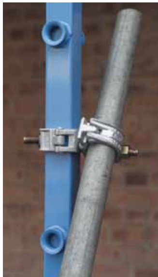
TREBEX specialkopplingar tillåter övergång från TREBEX fyrkantiga profil till runda rör, vilket kan vara användbart vid infästning av fackverksbalkar, stötrummor, mm.
